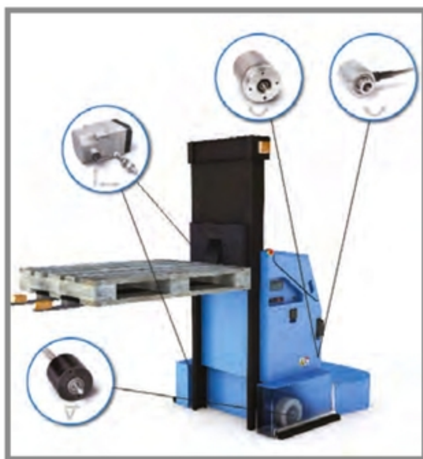
一款配备齐全的自动导向车：来自SIKO公司的强大传感器测量和控制所有重要动作，如速度、高度、倾角和转向角度
