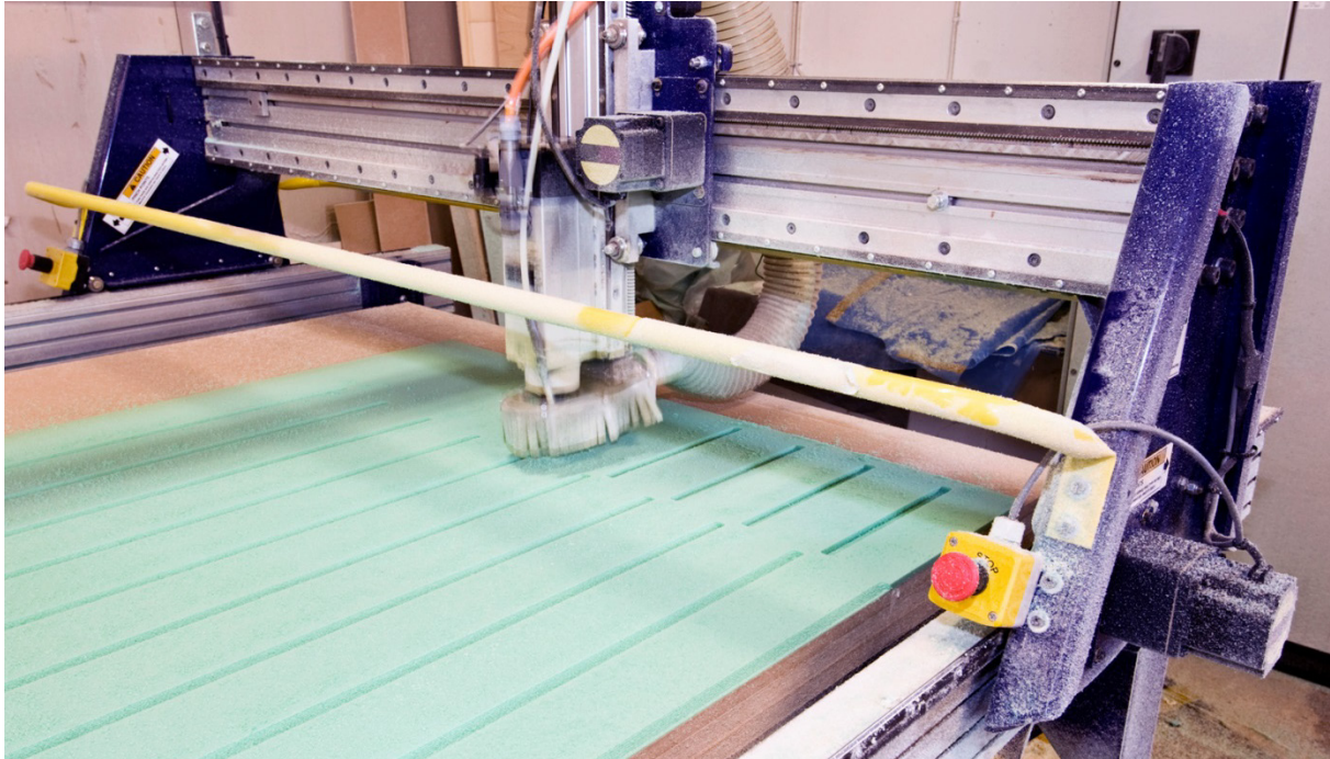
Abbildung 9: Auch bei Anwendungen mit sehr starken Verschmutzungen sind Motorfeedbacklösungen auf magnetischer Basis problemlos einsetzbar
