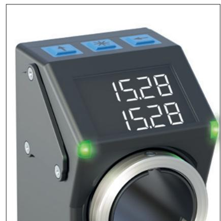
Die Zielposition wird als Sollwert an jedem Verstellpunkt angezeigt und eine rote/grüne Status-LED signalisiert, ob dort die Einstellung verändert werden muss. Bei korrekter Einstellung leuchten alle LEDs grün.
